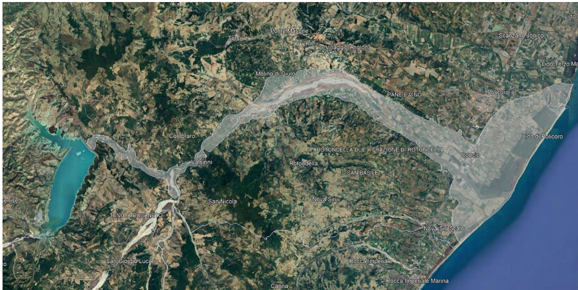
Fig. 4 Diga di Monte Cotugno - Onda di sommersione per collasso diga
