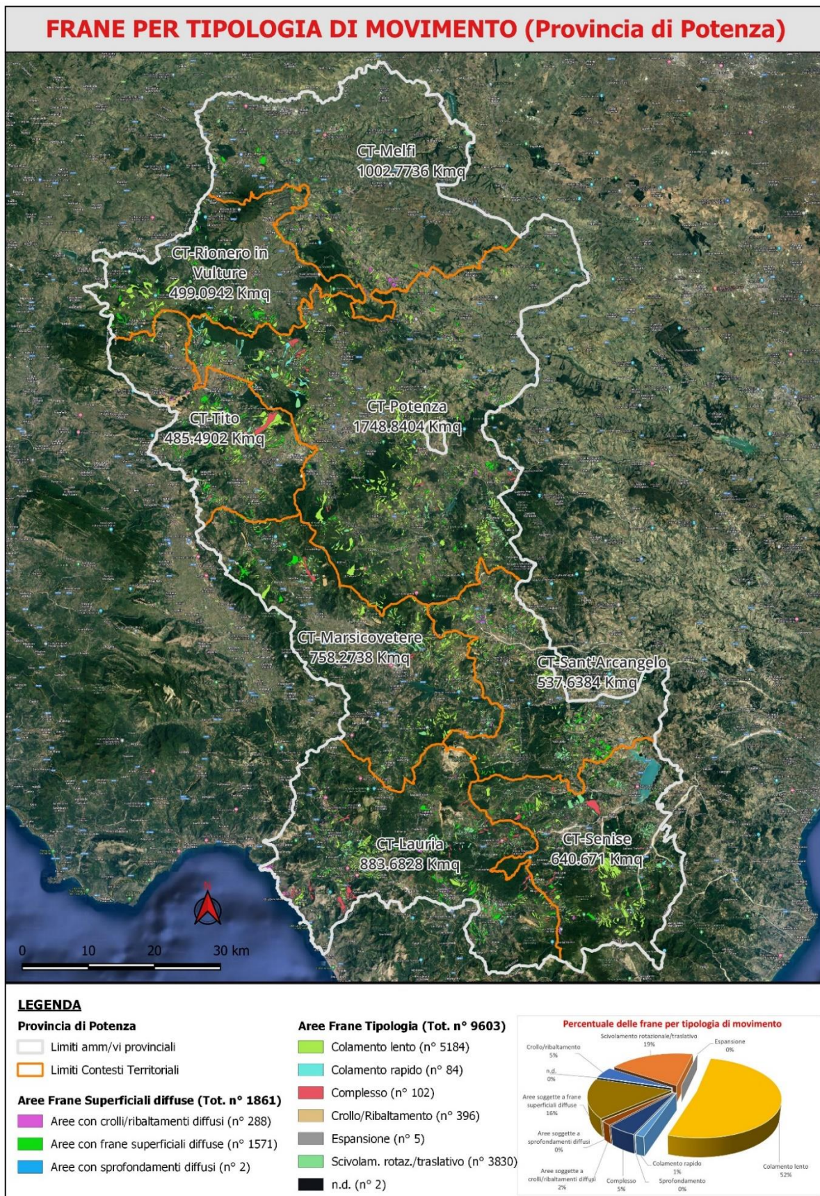
Fig. 2.3.2. - Mappa delle frane per tipo di movimento, relative al contesto di riferimento
